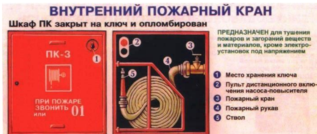
Рисунок 3 – Внутренний пожарный кран
