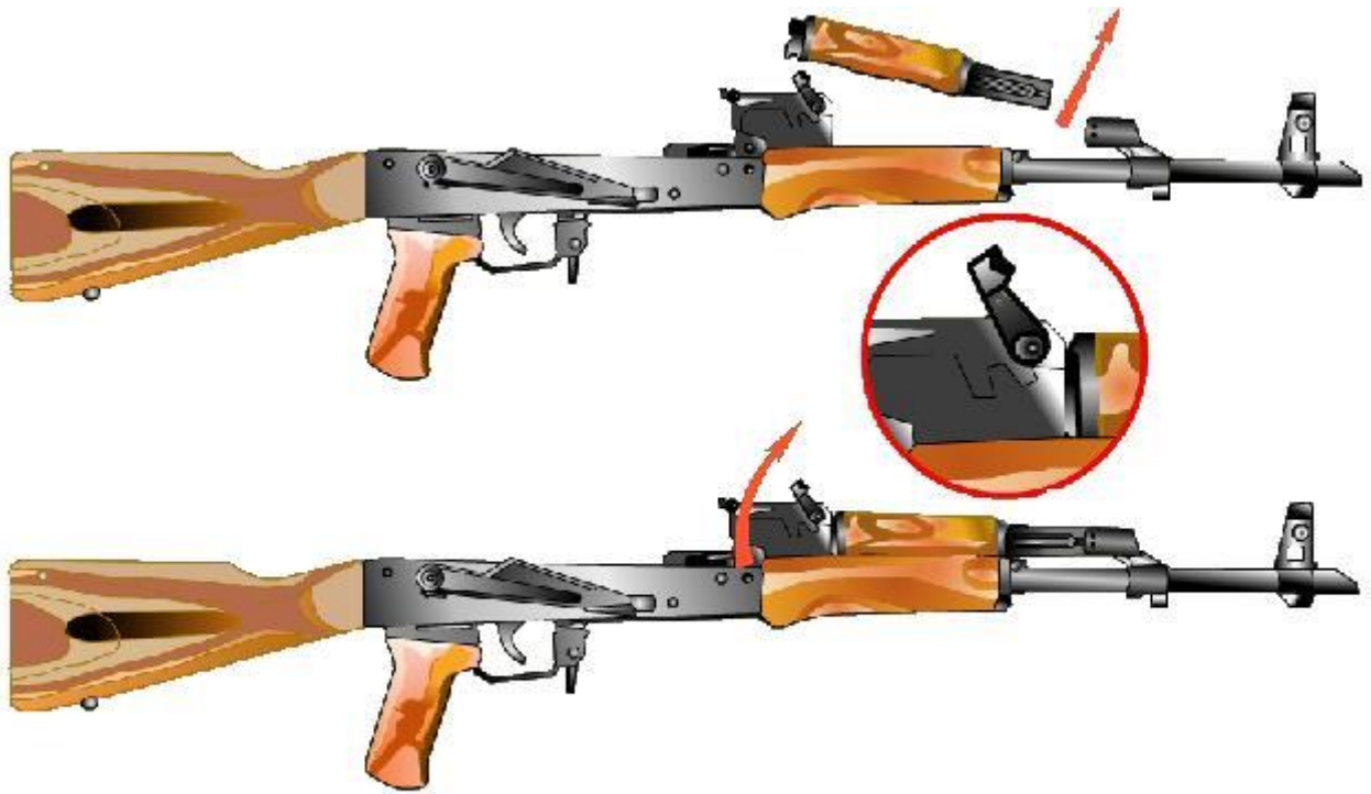
Рис. 9. Отделение газовой трубки со ствольной накладкой
